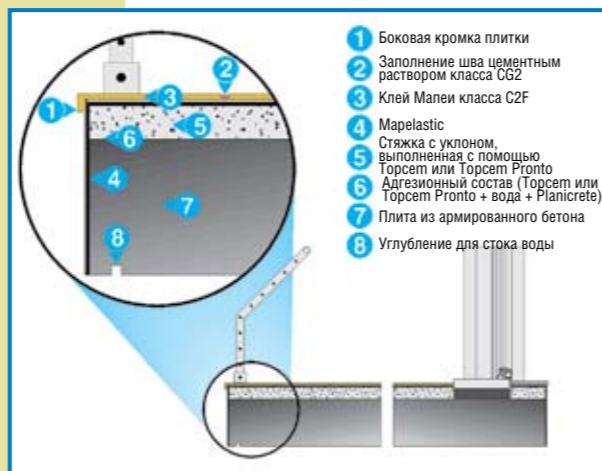
Фрагмент: гидроизоляция передней части балкона
